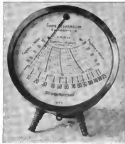
Abb. 266. Staudruck-Fahrtmesser mit Höhenkorrektur (Rosenmüller).
