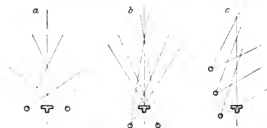
Abb. 302. Verteilung der Lichtquellen für Landbahnbeleuchtung.
