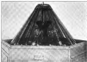
Abb. 304. Signalisierung durch Leuchtfeuer (Alig). (Farbgläser geschlossen.)
